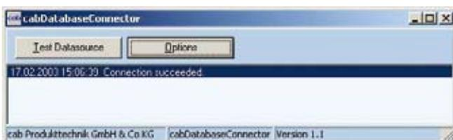
Im Stand-Alone-Modus über TCP/IP ermöglicht er es, Daten aus einer zentralen SQL-fähigen Datenbank direkt abzufragen und als Etikett zu drucken. Gleichzeitig können Daten während eines Druckvorgangs in die Datenbank zurückgeschrieben und verändert werden.
