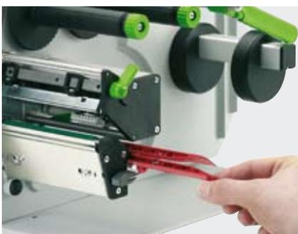
Die Lichtschranke wird mit einem Fingerdruck entriegelt und zum Reinigen herausgezogen.
