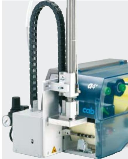
Mit dem Applikator werden die Etiketten direkt auf das Produkt aufgestempelt oder angeblasen.
